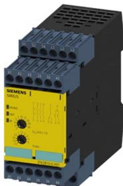
dispositivo di sicurezza SIRIUS di sicurezza sorveglianza di fermo AC 230 V, 45 mm morsetto a vite circuito di abilitazione istantaneo: 3 NO + 1 NC circuito di abilitazione ritardato: 0 circuito di segnalazione: 3 avvio automatico apparecchio di base cat. max. di errore EN 954-1: 4 PL max. raggiungibile secondo EN 13849-1: e SIL max. raggiungibile secondo IEC 61508: 3
