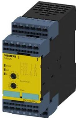
dispositivo di sicurezza SIRIUS di sicurezza sorveglianza di fermo DC 24 V, 45 mm morsetto a molla circuito di abilitazione istantaneo: 3 NO + 1 NC circuito di abilitazione ritardato: 0 circuito di segnalazione: 3 avvio automatico apparecchio di base cat. max. di errore EN 954-1: 4 PL max. raggiungibile secondo EN 13849-1: e SIL max. raggiungibile secondo IEC 61508: 3
