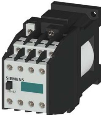
contattore ausiliario, 62E, DIN EN 50011, per applicazioni ferroviarie 6NO+2 NC, morsetto a vite campo di lavoro 0,7 ... 1,25 x US con varistore cablato DC 110V
