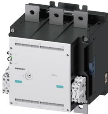
contattore sottovuoto AC-3e 630 A, 335 kW / 400 V, AC-3 820 A, 450 kW / 400 V, Ue 1000V, a 3 poli, Uc: AC 110...132 V(50/60Hz) azionamento: convenzionale
