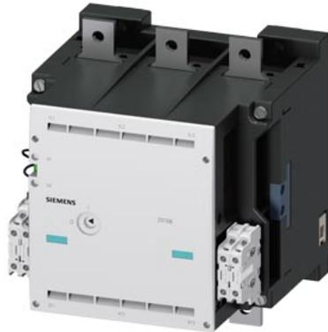
contattore sottovuoto AC-3e/AC-3 630 A, 335 kW / 400 V, U<sub>e</sub> 690V, a 3 poli, U<sub>c</sub>: AC 110...132 V(50/60Hz) azionamento: convenzionale contatti ausiliari 4 NO + 4 NC circuito princ.: sbarra circuito di comando e circuito ausiliario: attacco a vite
