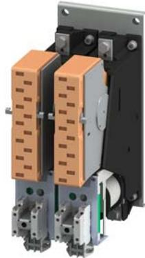
contattore grandezza costruttiva 12, a 2 poli DC-4, corrente di impiego nominale 400 A blocchetto di contatti ausiliari 4 NO + 4 NC comando in DC DC 24 V con varistore integrato
