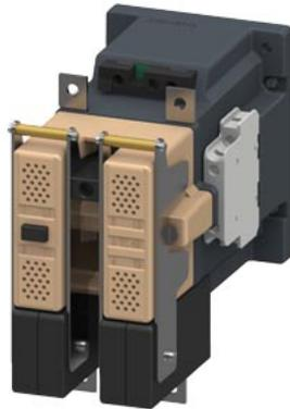
contattore grandezza costruttiva 4, a 2 poli DC 3 e 5, 75 A blocchetto di contatti ausiliari 22 (2 NO + 2 NC) azionamento in corrente continua DC 250 V
