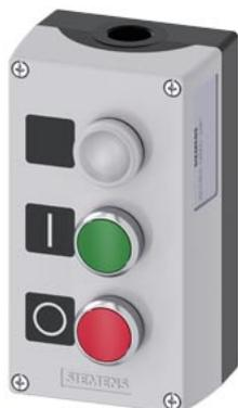
pulsantiera per dispositivi di comando, 22 mm, rotondo, materiale della pulsantiera metallo, parte superiore della pulsantiera grigia, 3 punti di comando in metallo, C=indicatore luminoso trasparente, targhetta, LED 24 V, morsetti a vite, B=pulsante verde, targhetta: I, 1 NO, morsetti a vite, A=pulsante rosso, targhetta: O, 1 NC, morsetti a vite, fissaggio sulla base di fondo, in alto e in basso risp. 1xM20, targhetta allegate
