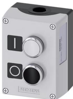
pulsantiera per dispositivi di comando, 22 mm, rotondo, materiale della pulsantiera metallo, parte superiore della pulsantiera grigia, 2 punti di comando in metallo, B=pulsante bianco, targhetta: I, 1 NO, morsetti a vite, A=pulsante nero,targhetta:O, 1 NC, morsetti a vite, fissaggio sulla base di fondo, in alto e in basso risp. 1xM20, targhette allegate
