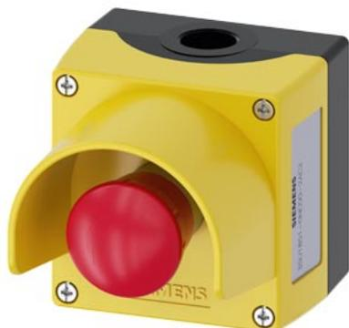
pulsantiera per dispositivi di comando 22 mm, rotondi, materiale della pulsantiera metallo, parte superiore della pulsantiera gialla, con collare di protezione, 1 punto di comando in metallo, A=pulsante a fungo di ARRESTO di EMERGENZA, rosso, 40 mm, con sblocco a rotazione, 1 NC, 1 NC, contatti dorati, morsetti a vite, fissaggio sulla base di fondo, in alto e in basso rispettivamente 1xM20
