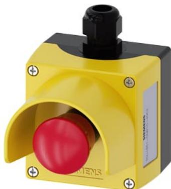
custodia AS-Interface per dispositivo di comando 22 mm, rotondo, materiale della custodia metallo, parte superiore della custodia gialla, con collare di protezione, 1 punto di comando in metallo, A=pulsante a fungo di arresto di emergenza rosso, 40 mm, con sblocco a rotazione, 1 NC, 1 NC, morsetto a molla, fissaggio sulla base di fondo, cavo profilato AS-I introduzione diretta in alto/a destra
