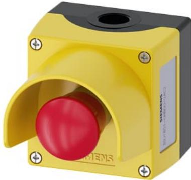
Pulsantiera per dispositivi di comando, 22 mm, rotondo, materiale della custodia metallo, parte superiore della custodia gialla, con collare di protezione, 1 punto di comando in metallo, A=pulsante a fungo di arresto di emergenza rosso, 40 mm, con sblocco a rotazione, 1 NC, 1 NC, morsetto a vite, fissaggio sulla base di fondo, in alto e in basso rispettivamente 1xM20
