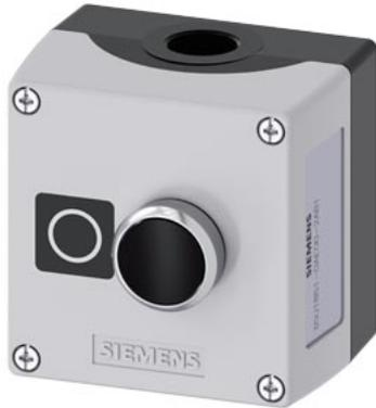
pulsantiera per dispositivi di comando, 22 mm, rotondo, materiale della pulsantiera metallo, parte superiore della pulsantiera grigia, 1 punto di comando in metallo, A=pulsante nero, 1 NC, morsetti a vite, fissaggio sulla base di fondo, targhetta: O, in alto e in basso risp. 1xM20, targhetta allegata
