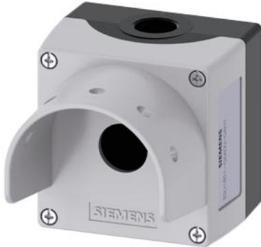
Pulsantiera per dispositivi di comando, 22 mm, rotondo, materiale della custodia metallo, parte superiore della custodia grigia, Con collare di protezione per 5 lucchetti, e diametro del fungo 60 mm 1 posto di comando, senza equipaggiamento, fissaggio sulla base di fondo, in alto e in basso rispettivamente 1xM20
