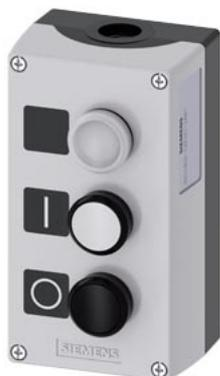
pulsantiera per dispositivi di comando, 22 mm, rotondo, materiale della pulsantiera plastica, parte superiore della pulsantiera grigia, 3 punti di comando plastica, C=indicatore luminoso trasparente, targhetta, LED 24 V, morsetti a vite, B=pulsante bianco, targhetta: I, 1 NO, morsetti a vite, A=pulsante nero, targhetta: O, 1 NC, morsetti a vite, fissaggio sulla base di fondo, in alto e in basso risp. 1xM20, targhetta allegate
