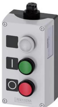
pulsantiera AS-Interface per dispositivi di comando, 22 mm, rotondo, materiale della pulsantiera plastica, parte superiore della pulsantiera grigia, 3 punti di comando plastica, rientranza per targhette, C=indicatore luminoso trasparente, targhetta senza scritta, B=pulsante verde, targhetta: I, 1 NO, morsetti a molla, A=pulsante rosso, targhetta: O, 1 NC, morsetti a molla, fissaggio sulla base di fondo, tecnica a perforazione d'isolante in alto, targhette allegate
