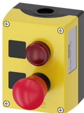
pulsantiera per dispositivi di comando, 22 mm, rotondo, materiale della pulsantiera plastica, parte superiore della pulsantiera gialla, 2 punti di comando in plastica, B=indicatore luminoso rosso, LED 24 V, morsetti a vite, targhetta senza scritta, A=ARRESTO DI EMERGENZA 40 mm con sblocco a rotazione, targhetta senza scritta, 1 NO, 1 NC, 1 NC, morsetti a vite, fissaggio sulla base di fondo, in alto e in basso risp. 1xM20, targhettae allegate
