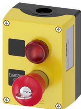
pulsantiera per dispositivi di comando 22 mm, rotondo, materiale della pulsantiera plastica, parte superiore della pulsantiera gialla, 2 punti di comando in plastica, B = indicatore luminoso, rosso, LED AC/DC 24 V, morsetti a vite, targhetta senza iscrizione, A= ARRESTO DI EMERGENZA, 40 mm, RONIS SB30, targhetta con iscrizione: EMERGENCY STOP, 1 NO, 1 NC, morsetti a vite, fissaggio sulla base di fondo, in alto e in basso rispettivamente 1xM20, targhette allegate
