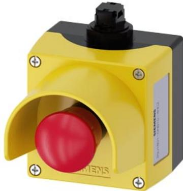
custodia AS-Interface per dispositivo di comando 22 mm, rotondo, materiale della custodia plastica, parte superiore della custodia gialla, con collare di protezione, 1 punto di comando in plastica, A=pulsante a fungo di arresto di emergenza rosso, 40 mm, con sblocco a rotazione, 1 NC, 1 NC, morsetto a molla, fissaggio sulla base di fondo, tecnica a perforazione d'isolante in alto
