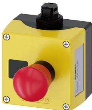
pulsantiera AS-Interface per dispositivi di comando, 22 mm, rotondo, materiale della pulsantiera plastica, parte superiore della pulsantiera gialla, 1 punto di comando in plastica, rientranza per targhetta, A=pulsante a fungo di ARRESTO DI EMERGENZA rosso, 40 mm, con sblocco a rotazione, 1 NC, 1 NC, morsetti a molla, fissaggio sulla base di fondo, tecnica a perforazione d'isolante in alto, targhetta allegata
