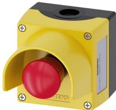
custodia per dispositivi di comando, 22 mm, rotondo, materiale della custodia plastica, parte superiore della custodia gialla, 1 punto di comando in plastica, con collare di protezione, A=pulsante a fungo di arresto di emergenza rosso, 40 mm, con sblocco a rotazione, 1 NC, morsetto a vite, fissaggio sulla base di fondo, in alto e in basso rispettivamente 1xM20
