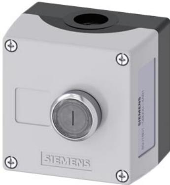
pulsantiera per dispositivi di comando 22 mm, rotondo, materiale della pulsantiera plastica, parte superiore della pulsantiera grigia, 1 posto di comando, A = pulsante luminoso, trasparente, in metallo, 1 NO, LED 24 V, morsetti a molla, fissaggio sulla base di fondo, morsetto di supporto, targhetta: I, in alto e in basso rispettivamente 1xM20
