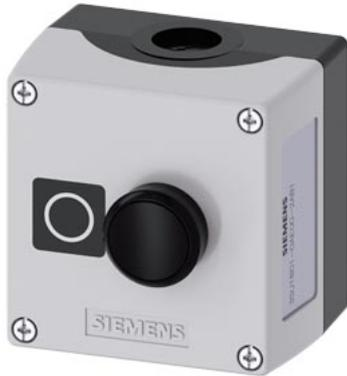
pulsantiera per dispositivi di comando, 22 mm, rotondo, materiale della pulsantiera plastica, parte superiore della pulsantiera grigia, 1 punto di comando in plastica, rientranza per targhetta, A=pulsante nero targhetta: O 1 NC, morsetti a vite, fissaggio sulla base di fondo, targhetta allegata
