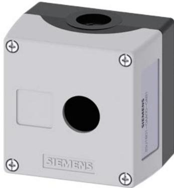
pulsantiera per dispositivi di comando, 22 mm, rotondo, materiale della pulsantiera plastica, parte superiore della pulsantiera grigia, 1 punto di comando in plastica, rientranza per targhetta, senza equipaggiamento
