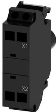
modulo LED con LED integrato AC/DC 24 V, rosso, morsetti a molla, per fissaggio su piastra frontale, min. quantità ordinabile 5 o un suo multiplo
