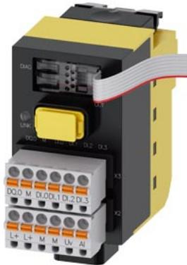
SIRIUS ACT con PROFINET: modulo d'interfaccia fail-safe con 4 DI, 1 DQ (DC 24 V), 1 AI (risoluzione A/D da 12 bit), DC 24 V, morsetti a molla, fissaggio su piastra frontale, da 1 a 20 moduli terminali collegabili
