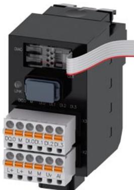
SIRIUS ACT con PROFINET: modulo di interfaccia standard con ingressi e uscite ampliati DC 24V, morsetti a molla, fissaggio su piastra frontale, da 1 a 20 moduli terminali collegabili, con 1DQ+4DI+1AI aggiuntivi
