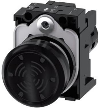
segnalatore acustico, compatto, 22 mm, rotondo, plastica, nero, suono continuo 4,5 kHz, IP69, pressione acustica 75+/-10% dB/10 cm, con supporto, tensione di esercizio AC 230V, morsetti a vite
