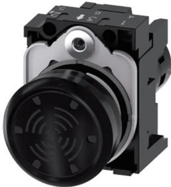
segnalatore acustico, compatto, 22 mm, rotondo, plastica, nero, suono continuo 4,5 kHz, IP69, pressione acustica 75+/-10% dB/10 cm, con supporto, tensione di esercizio AC/DC 24V, morsetti a vite
