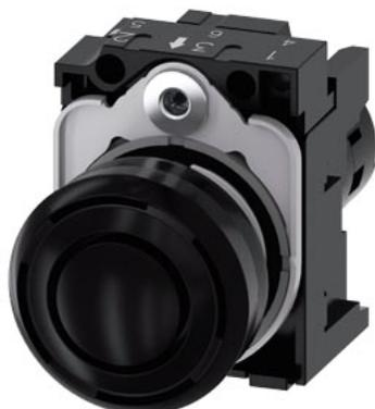
segnalatore acustico, compatto, 22 mm, rotondo, in plastica, nero, suono continuo 2,4 kHz, IP40 pressione acustica min. 80 db./10 cm, con supporto, tensione di esercizio AC/DC 24V, morsetti a vite
