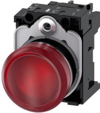
indicatore luminoso, 22 mm, rotondo, in metallo, lucido, rosso, lente, liscio, con supporto, modulo LED con LED integrato AC 110 V, morsetto a vite
