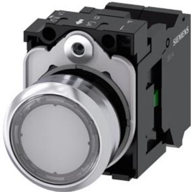
pulsante luminoso, 22 mm, rotondo, in metallo, lucido, trasparente, bottone, piatto, ad impulso, con supporto, 1 NO, modulo LED con LED integrato AC 110 V, morsetto a molla
