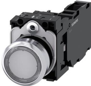
pulsante luminoso, 22 mm, rotondo, in metallo, lucido, trasparente, bottone, piatto, ad impulso, con supporto, 1 NO+1 NC, modulo LED con LED integrato AC 110 V, morsetto a vite
