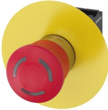
pulsante a fungo di ARRESTO DI EMERGENZA, illuminabile, 22 mm, rotondo, in metallo, lucido, rosso, 40 mm, permanente con blocco positivo, secondo EN ISO 13850, sblocco a rotazione, con disco targhetta giallo, senza iscrizione, con supporto, 1 NC, 1 NC, LED 24 V rosso, morsetti a molla, fissaggio su piastra frontale
