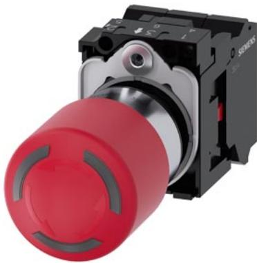
pulsante a fungo di ARRESTO DI EMERGENZA, illuminabile, 22 mm, rotondo, in metallo, lucido, rosso, 30 mm, permanente con blocco positivo, secondo EN ISO 13850, sblocco a rotazione, disco targhetta per ARRESTO DI EMERGENZA, giallo, senza iscrizione, con supporto, 1 NC, 1 NC, modulo LED 24 V rosso, morsetti a molla, fissaggio su piastra frontale
