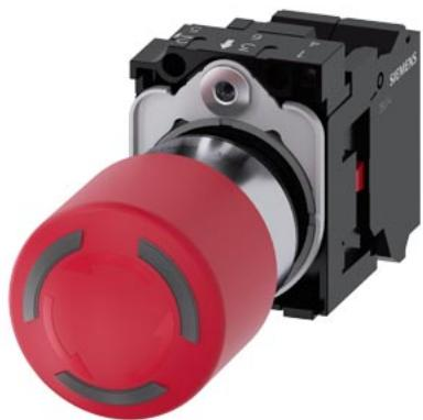
pulsante a fungo di ARRESTO DI EMERGENZA, illuminabile, 22 mm, rotondo, in metallo, lucido, rosso, 30 mm, permanente con blocco positivo, secondo EN ISO 13850, sblocco a rotazione, disco targhetta per ARRESTO DI EMERGENZA, giallo, senza iscrizione, con supporto, 1 NC, modulo LED 24 V rosso, morsetti a molla, fissaggio su piastra frontale
