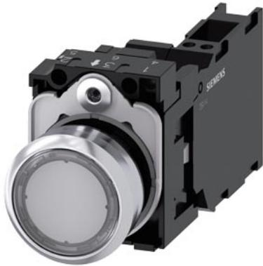
pulsante luminoso, 22 mm, rotondo, in metallo, lucido, trasparente, bottone, piatto, ad impulso, con supporto, 1 NO+1 NC, modulo LED con LED integrato AC/DC 24V, morsetto a molla
