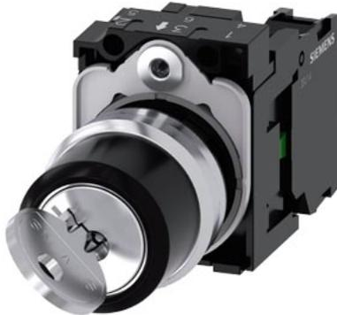
selettore a chiave RONIS, 22 mm, rotondo, in metallo, lucido, numero serratura SB30, con 2 chiavi, 2 posizioni di commutazione O-I, permanente, angolo di comando 90°, 10:30h/13:30h, estrazione chiave O+I, con supporto, 1 NO, morsetti a vite, possibili serrature speciali: SB31, 421, 455
