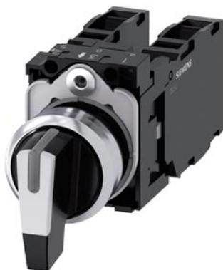
selettore, 22 mm, rotondo, in metallo, lucido, bianco, selettore, lungo, 3 posizioni di commutazione I>O<II, ad impulso, angolo di comando 2x45°, 10:30 h/12 h/13:30 h, con supporto, 1 NO, 1 NO, morsetti a vite
