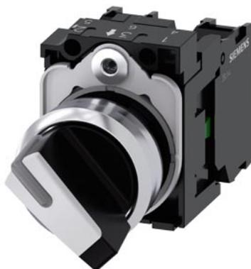
selettore, illuminabile, 22 mm, rotondo, in metallo, lucido, bianco, selettore, breve, 2 posizioni di commutazione O-I, permanente, angolo di intervento 90°, 10:30 h/13:30 h, con supporto, 1 NO, 1 NC, morsetto a vite
