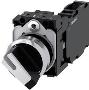
selettore, illuminabile, 22 mm, rotondo, in metallo, lucido, bianco, selettore, breve, 2 posizioni di commutazione O-I, permanente, angolo di intervento 90°, 10:30 h/13:30 h, con supporto, 1 NO+1 NC, morsetto a vite
