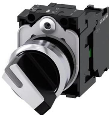
selettore, 22 mm, rotondo, in metallo, lucido, bianco, selettore, corto, 2 posizioni di commutazione O<I, ad impulso, angolo di comando 45°, 10:30 h/12 h, con supporto, 1 NO, morsetti a vite
