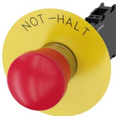
pulsante a fungo di ARRESTO DI EMERGENZA, 22 mm, rotondo, metallo, lucido, rosso, 40 mm, permanente con blocco positivo, secondo EN ISO 13850, sblocco a trazione, con disco targhetta giallo, iscrizione: NOT-HALT, con supporto, 1 NO+1 NC, morsetti a molla
