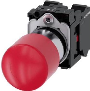
pulsante a fungo di ARRESTO DI EMERGENZA, 22 mm, rotondo, in metallo, lucido, rosso, 30 mm, permanente con blocco positivo, secondo EN ISO 13850, sblocco a rotazione, disco targhetta per ARRESTO DI EMERGENZA, giallo, 60mm, senza iscrizione, con supporto, 1 NC, 1 NC, morsetti a molla, fissaggio su piastra frontale
