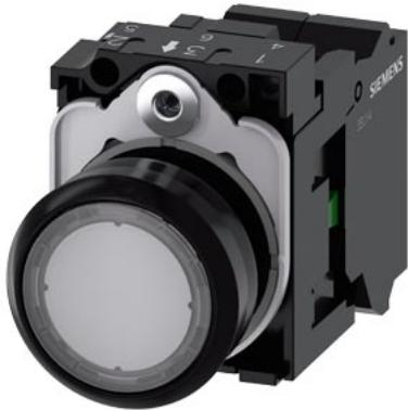
pulsante luminoso, 22 mm, rotondo, in plastica, trasparente, bottone, piatto, ad impulso, con supporto, 1 NO, modulo LED con LED integrato AC 230 V, morsetto a molla
