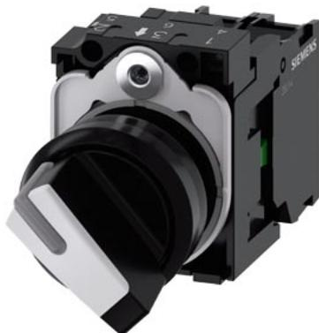
selettore, illuminabile, 22 mm, rotondo, plastica, bianco, selettore, corto, 2 posizioni di commutazione O-I, permanente, 10:30 h/13:30 h, con supporto, con modulo LED, verde, con LED integrato AC 110 V, 1 NO, morsetti a vite
