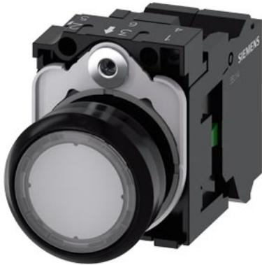
pulsante luminoso, 22 mm, rotondo, in plastica, trasparente, bottone, piatto, ad impulso, con supporto, 1 NO, modulo LED con LED integrato AC 110 V, morsetto a molla
