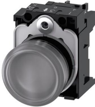
indicatore luminoso, 22 mm, rotondo, in plastica, trasparente, lente, liscio, con supporto, modulo LED, con LED integrato AC/DC 24V, morsetto a vite
