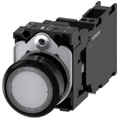
pulsante luminoso, 22 mm, rotondo, in plastica, trasparente, bottone, piatto, ad impulso, con supporto, 1 NO+1 NC, modulo LED con LED integrato AC/DC 24V, morsetto a molla
