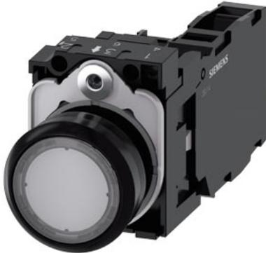
pulsante luminoso, 22 mm, rotondo, in plastica, trasparente, bottone, piatto, ad impulso, con supporto, 1 NO+1 NC, modulo LED con LED integrato AC/DC 24V, morsetto a vite
